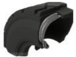
Es ist wichtig, dass der Reifendruck regelmässig kontrolliert und eingehalten wird. Ein zu niedriger oder zu hoher Reifendruck führt zu vorzeitigem Ausfall, erhöhtem Kraftstoffverbrauch und höheren Betriebskosten.
